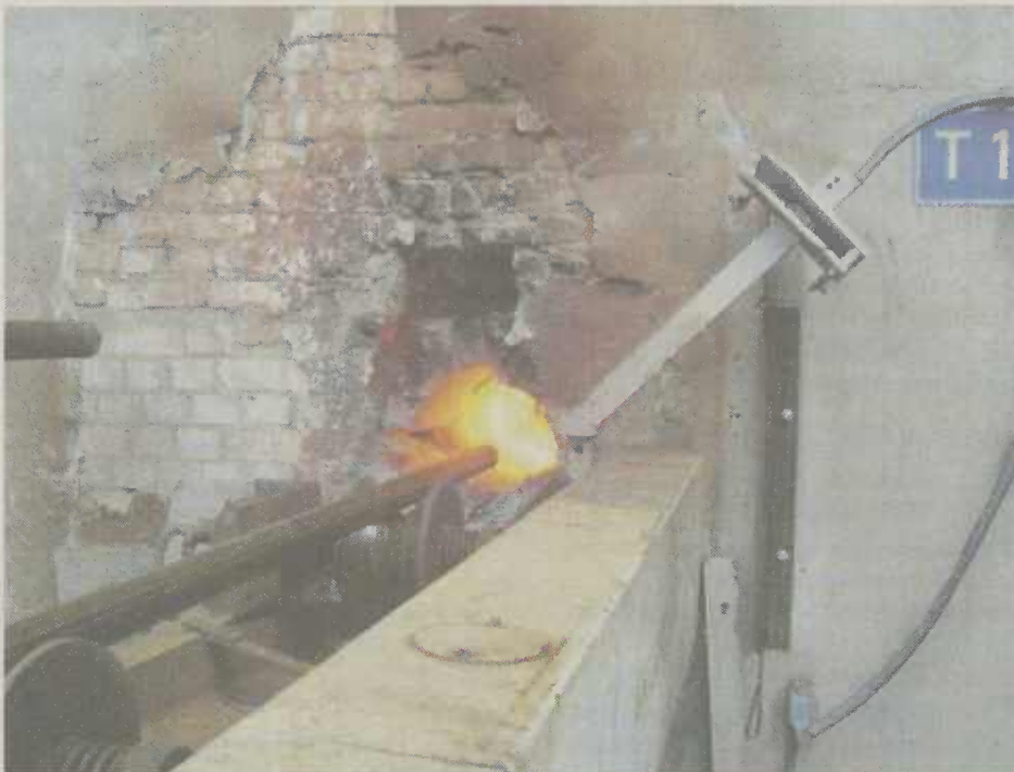
Erhitzen einer Stahlstange bei der Gesenkschmiede Schneider in Aalen vor dem Schneiden und Scheren, damit keine Spannungsrisse im Stahl entstehen.
