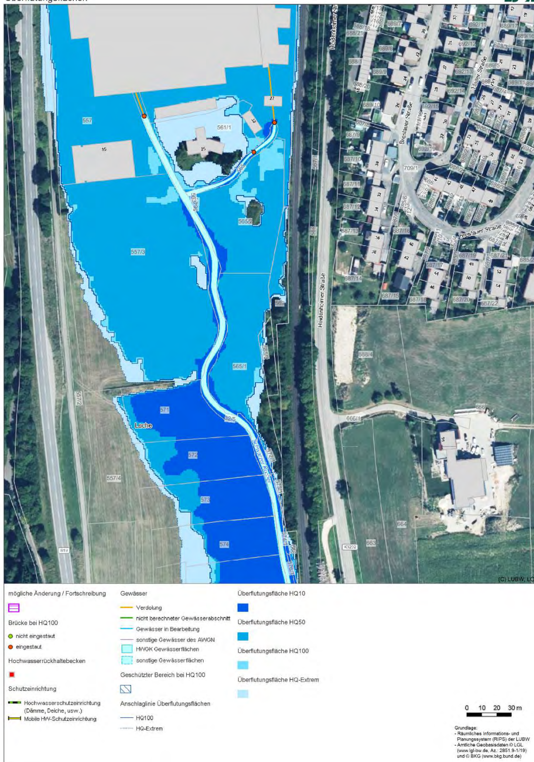
Abb. 6 Überflutungsflächen im Planbereich vor der neuen Hochwasserschutzkonzeption, unmaßstäblich, Quelle siehe Planeinschreibung
