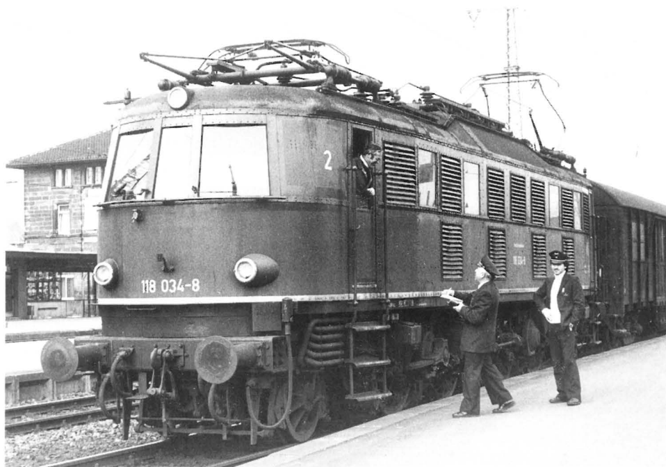
Der Zugführer des Eilzuges Aalen–Stuttgart übergibt vor Fahrtbeginn an den Aalener Lokführer den Betriebsleistungszettel und den Bremszettel des Zuges. Die E-Lok gehörte zur Baureihe E 18, später 118, Schnellzuglok, 150 km/h, Starrahmenbauart, Achsfolge 1'Do1', 3040 kW Stundenleistung.
