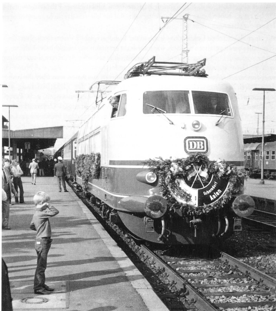
Eine Schnellzuglokomotive der Baureihe E 03 (später 103, 200 km/h, 7080 kW) vor einem Sonderzug im Bahnhof Aalen, den Abfahrauftrag erwartend. Anlaß für die Sonderfahrt war die Eröffnung der elektrifizierten Strecke Schorndorf–Aalen.
