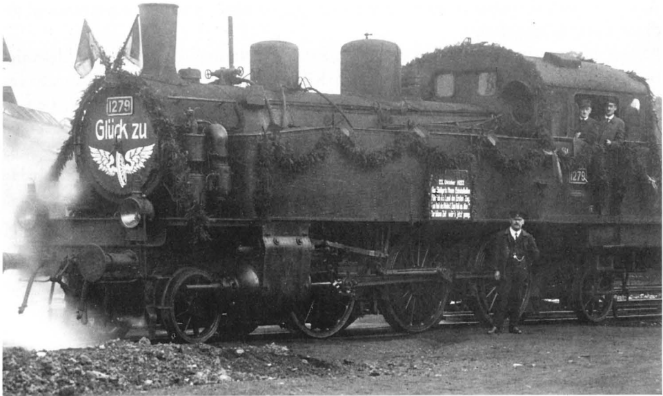
Eine württembergische Tenderlokomotive der Bauart T 5, gebaut von der Maschinenfabrik Esslingen. Diese festlich geschmückte Lokomotive mit Personal aus Aalen zog am 23. Oktober 1922 um 4.15 Uhr den ersten Personenzug aus den neuen Stuttgarter Bahnhofshallen nach Aalen.
