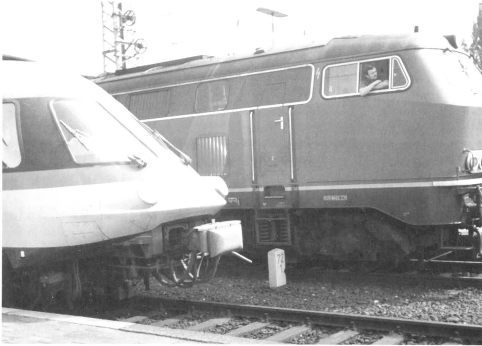
Dieselhydraulische Lokomotive der Reihe 215 mit Triebfahrzeugführer aus Aalen. Links im Bild der Führerstand eines in Aalen sehr selten gesehenen elektrischen Triebfahrzeuges, des InterCity-Triebzuges der Baureihe 403, 200 km/h schnell, mit abgedeckter Mittelpufferkupplung. Von dieser Baureihe wurden nur drei Züge gebaut; sie verkehrten zwischen München und Bremen und dann mehrere Jahre als Lufthansa Airport-Express (gelb-grau-weiß lackiert) zwischen Frankfurt/Main und Düsseldorf. Vor dem Einstieg 2 in die Diesellok steht noch der Kilometerstein 72,1 der Remsbahnstrecke.
