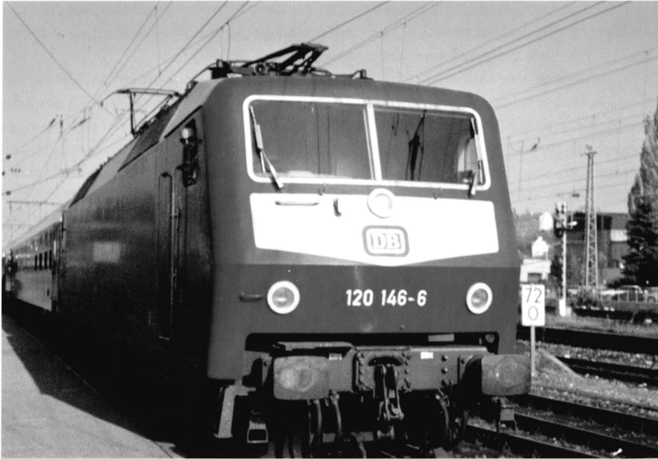
Eine E-Lokomotive der Reihe 120 vor dem InterRegio Görlitz–Dresden–Nürnberg–Karlsruhe bei einem Zwischenhalt in Aalen. Die Maschine hat 5600 kW Antriebsleistung und ist 200 km/h schnell; im Führerstand kein Aalener Personal. Rechts im Bild die Kilometertafel 72,0 der Remsbahnstrecke; 1993.
