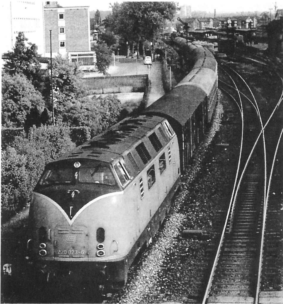
Der Schnellzug Nürnberg–Stuttgart nach einem Zwischenhalt in Aalen auf der Fahrt direkt vor dem ehemaligen Bahnübergang „Neue Welt“ (Alte Heidenheimer Straße) in die Steigung nach Essingen. Die schwer arbeitende Lok – ohne sichtbare Abgaswolke – ist eine dieselhydraulische Lok der Baureihe V 200 (später 220), 140 km/h schnell; im Führerstand kein Aalener Personal; 1969.
